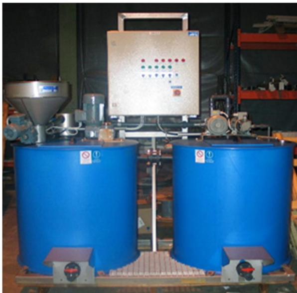
Рисунок 12 – Общий вид станции приготовления и дозирования реагентов
