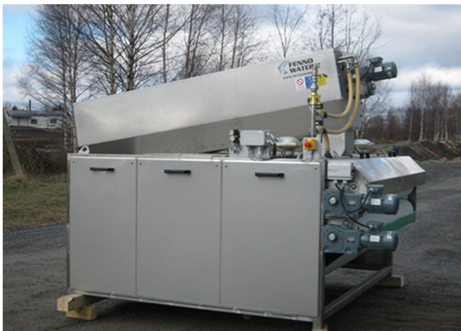
Рисунок 15 - Ленточный фильтр-пресс с барабанным сгустителем
